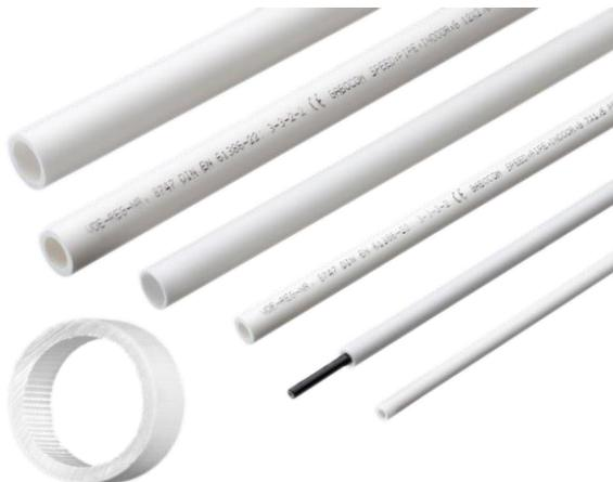
**Назначение:** микротрубка предназначена для прокладки внутри помещений и рассчитана для последующей задувки микрокабелей диаметром 1,0-2,0 мм. Данный продукт, является составной частью общего решения для строительства внутридомовых сетей, главным аспектом, которого является пожаробезопасность, низкодымность и отсутствие вредных веществ при горении.
